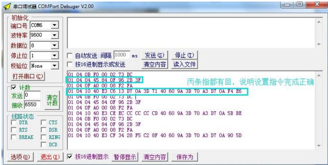
7) 取下 USB-RS485 接口, 接到 SM100-B ARS485 输出口进行通讯测试
