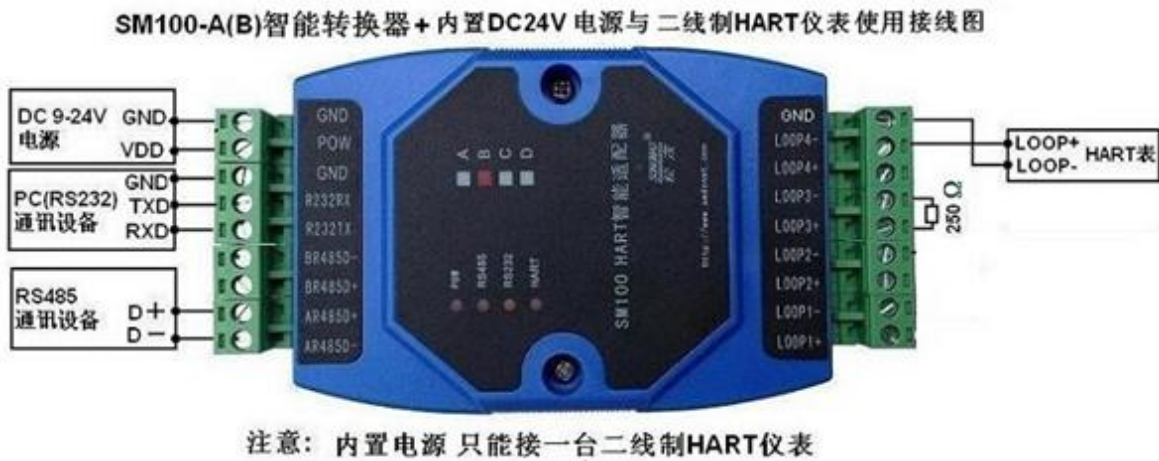
(4) HART 转换器内置 DC24V 与二线制 HART 协议智能仪表接线图
