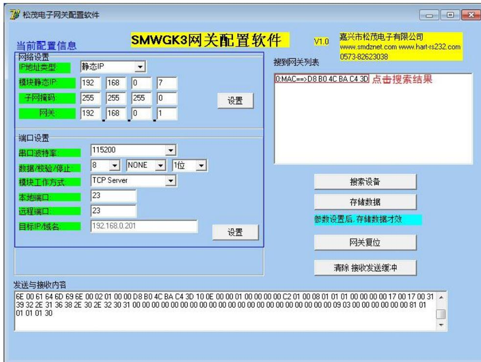
4) 用户在计算机中查询本地 Internet 协议 (TCP/IP) 属性，根据查询结果进行以太网网络参数设置。其中串口波特率—115200，校验/数据/停止—NONE、8、1 为固定值，不可更改。IP 地址的最后一个字节不同，用户可自行定义。
