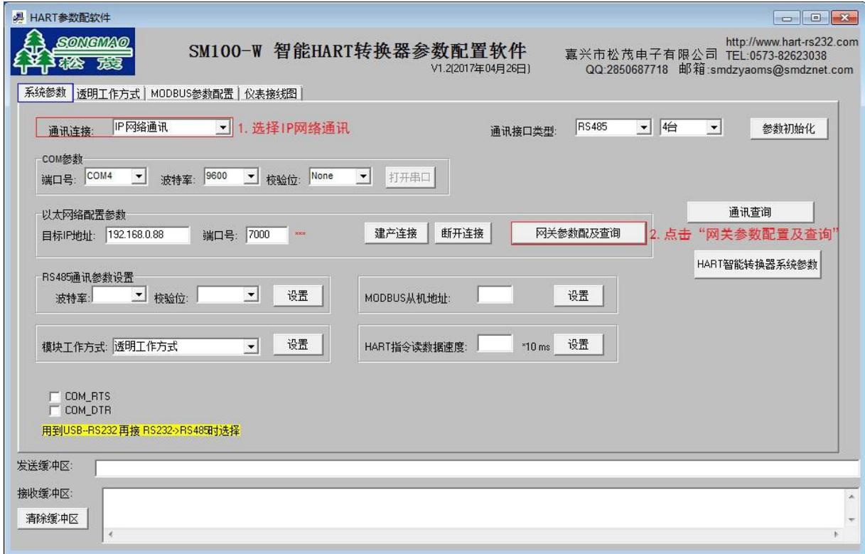
2) 在弹出的窗口中点击“搜索设备”，搜索本台转换器的网关设备，搜索结果显示在右上方白色窗口中。
